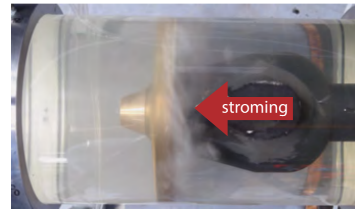
Caviterende thruster - ANS off
